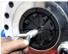
Realizamos prensado de cables de acero rígido.
